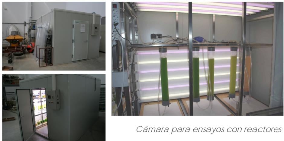
*Cámara para ensayos con reactores*
